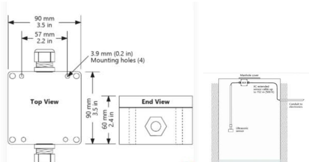
Соединительная коробка для кабеля датчика JB2X - это дополнительная водонепроницаемая соединительная коробка из поликарбоната NEMA4X (IP66) с доступными клеммными колодками.
