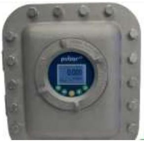
Взрывозащищенный корпус модели CXJ8106 предназначен для корпуса электроники продукта Greyline. Этот корпус соответствует стандартам UL и CSA для использования во взрывоопасных зонах. Он имеет смотровое окошко, а калибровочная клавиатура активируется магнитом через стеклянное окошко.
