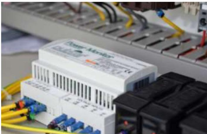
Монитор мощности позволяет контролировать потребление энергии и дополнительно конкретные электрические параметры нагрузки, обычно двигателя. Дополнительное аппаратное и программное обеспечение позволяет осуществлять мониторинг производительности и безопасности. Power Monitor может работать как с однофазными, так и с трехфазными системами.
