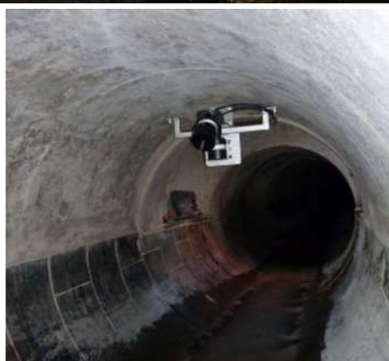
MicroFlow-i - это решение для бесконтактного измерения скорости. Чрезвычайно низкое энергопотребление делает его идеальным решением для измерения скорости в удаленных точках доступа к канализационной сети, которые труднодоступны и часто не имеют электропитания. Объедините MicroFlow-i с [интеллектуальным преобразователем dVi](#) для получения полного, маломощного, бесконтактного решения для измерения площади скорости.
