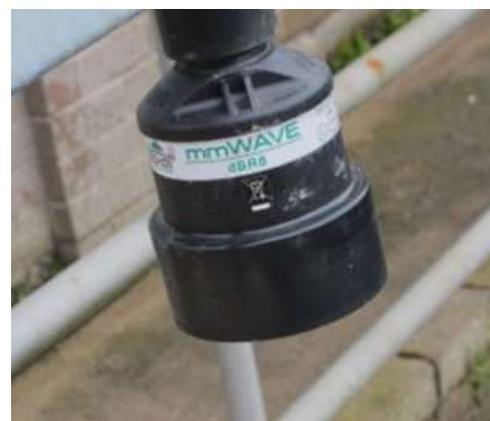
Серия датчиков dBR radar - это линейка радарных датчиков уровня, которые идеально подходят для сложных приложений, таких как высокие температуры, приложения, подверженные пене или атмосферным изменениям, или приложениям с агрессивными химическими веществами, которые выделяют пары.
