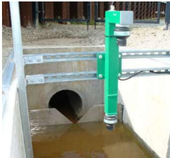
Бесконтактное измерение расхода в открытом канале сложно выполнить правильно, особенно когда потребность в точных и надежных показаниях расхода постоянно возрастает. DUET - это уникальный продукт в котором используется запатентованный подход к решению проблемы точности бесконтактного измерения расхода в открытом канале.
