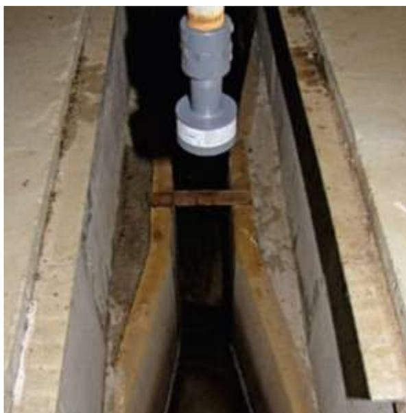
OCF 6.1 - это расходомер с открытым каналом, который можно использовать в качестве измерителя уровня в резервуаре, что делает его идеальным решением для бесконтактного измерения расхода и уровня. Бесконтактный расходомер с открытым каналом может непрерывно отслеживать, отображать, суммировать и регистрировать поток данных через любой лоток или водослив. Ультразвуковой датчик, поставляемый с OCF 6.1, устанавливается всего на 203,2 мм (8 дюймов) над проточной водой, обеспечивая точность +/- 0,25%.
